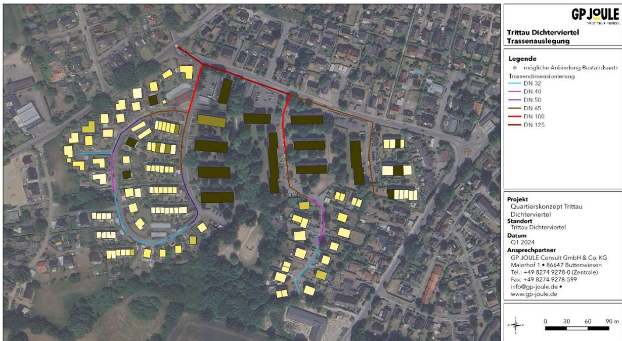
Abbildung 46: Trassierung des Dichterviertels Trittau bis zu einem möglichen Anschlusspunkt an das Wärmebestandsnetz der Hansewerk Natur GmbH (Quelle: GP Joule)
