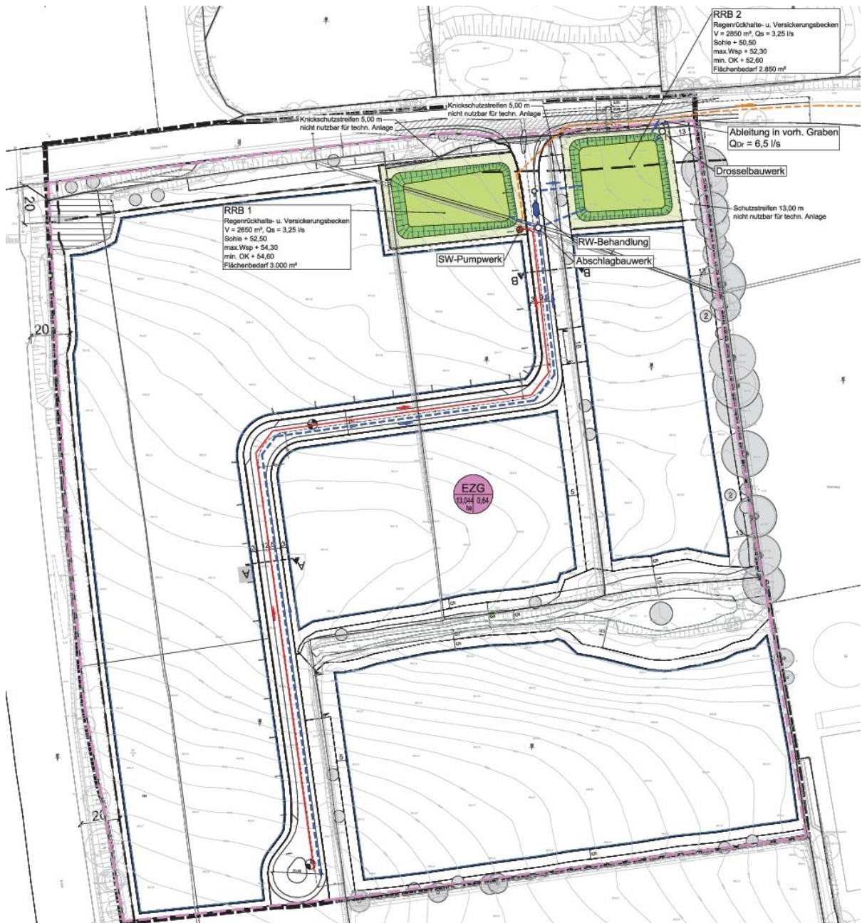
Abbildung 36: Auszug aus dem Entwässerungskonzept (Ingenieurbüro Masuch + Olbrisch Ingenieurgesellschaft für das Bauwesen mbH)
